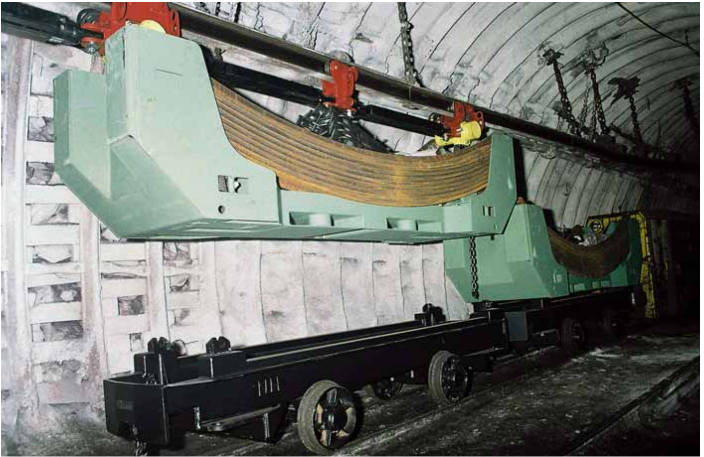
Překládka TH kontejneru z kolejového podvozku na závěsnou dráhu
